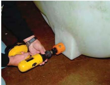
**CUIDADO:** segure bem a furadeira com as duas mãos, pois ela tende a rodopiar quando a serra copo encosta no tanque e começa a abrir o furo. Aplique pressão bem suave enquanto a furadeira estiver girando. Durante o corte do furo, não force a serra de encontro ao tanque para evitar que ela escape das suas mãos!!!
