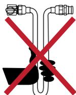
**ATENÇÃO: NUNCA use o trocador de calor como a alavanca para conectar a ele a mangueira ou o Venturi.**
